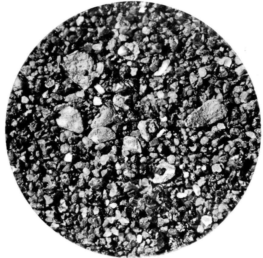
Examen al microscopio de los residuos de lavado, en que se observan pepitas de oro, trozos de ilmenita, magnetita, casiterita, wolfram y algo de cuarzo y feldespato.
