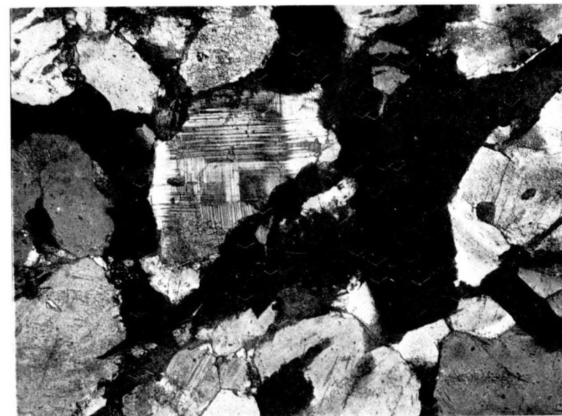
530. — Sienita . — Microclino rodeado de lepidomelana y magnetita, n. c. \times 50 .
