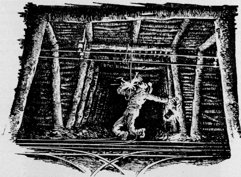
Fig. 154.—Un alambre colgado de los hilos de toma de corriente para locomotora puede causar una muerte.
