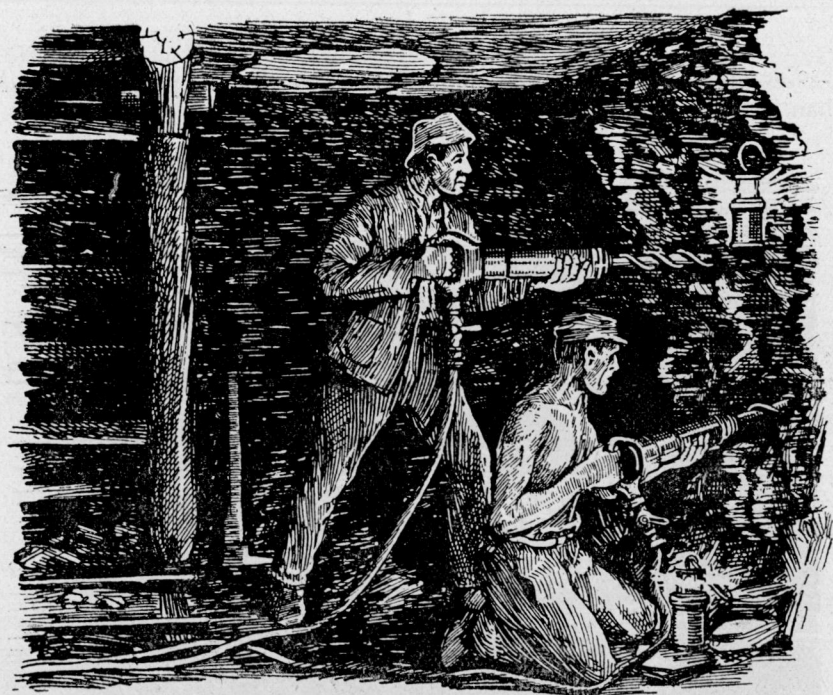
Fig. 124.—Avance imprudente bajo un pastión suelto.
