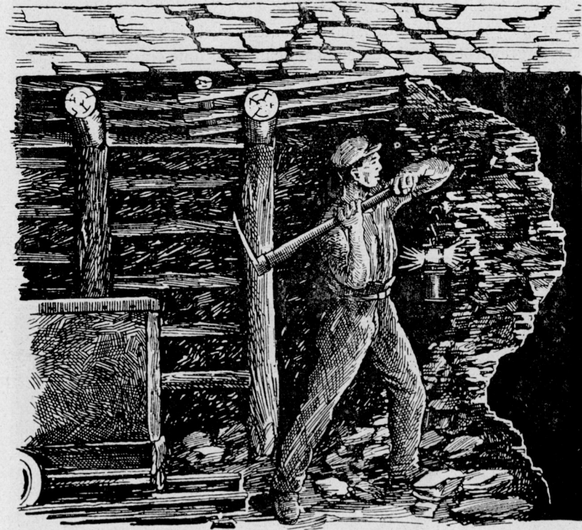
Fig. 133.—Agujas de avance con voladizo demasiado largo. ¡Labor peligrosa!
