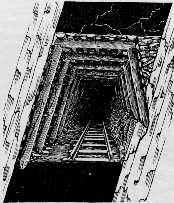
Fig. 131.—Balseo peligroso de un pie al muro de la capa.
