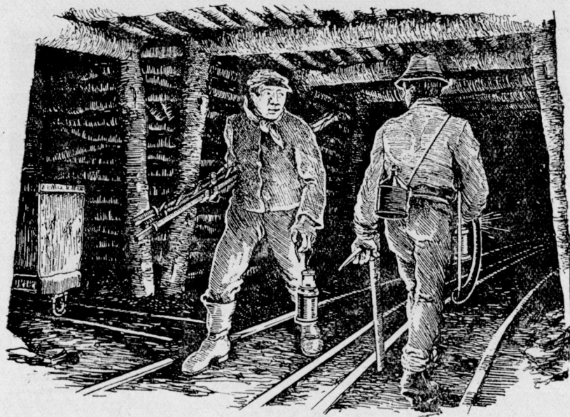
Fig. 144.—Lleva tu herramienta bajo el brazo y camina por la vía que corresponde al sentido de tu marcha.
