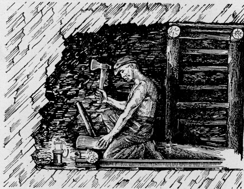
Fig. 140.—Trabajo peligroso por colocarse bajo unos lisos sin posteo.
