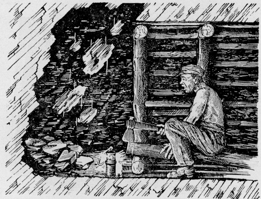
Fig. 142.—Prepara tu madera colocándote siempre debajo de una entibación segura.
