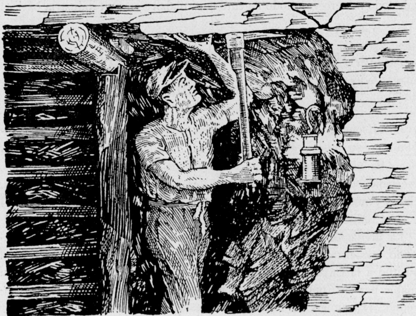
Fig. 114.—No hagas nunca el toque de los lisos sospechosos colocándote debajo.
