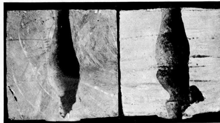
Bloques defectuosos fundidos por la industria privada.
