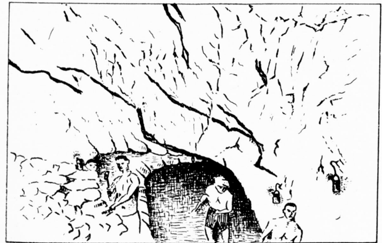
Mina «Impensada»: Frente de un anchurón en el que se explotan varias vetas del filón «San Rafael» en el nivel 380 metros. En la fotografía se distinguen varias vetas mineralizadas.
