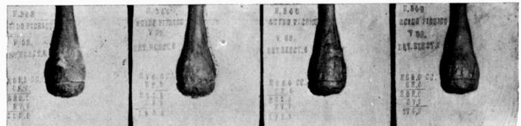
Juego de bloques de la determinación del efecto útil de un explosivo.
