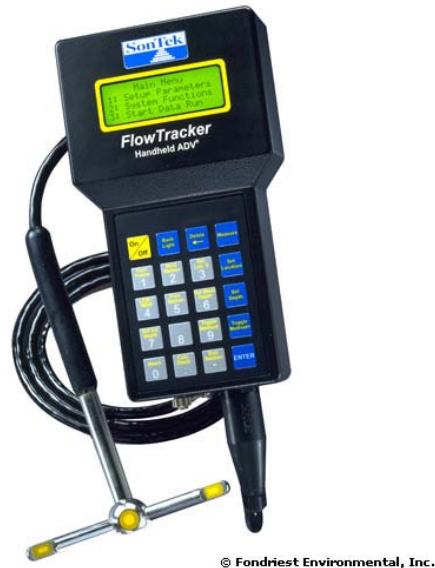
Figura 3.- Equipo de medida de caudal modelo FlowTracker.
