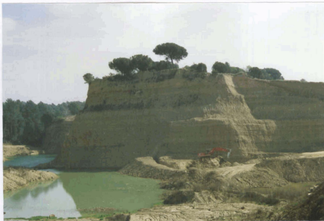
Foto núm. 4. Explotación de arcillas miocénicas en el término de Sardañola.
