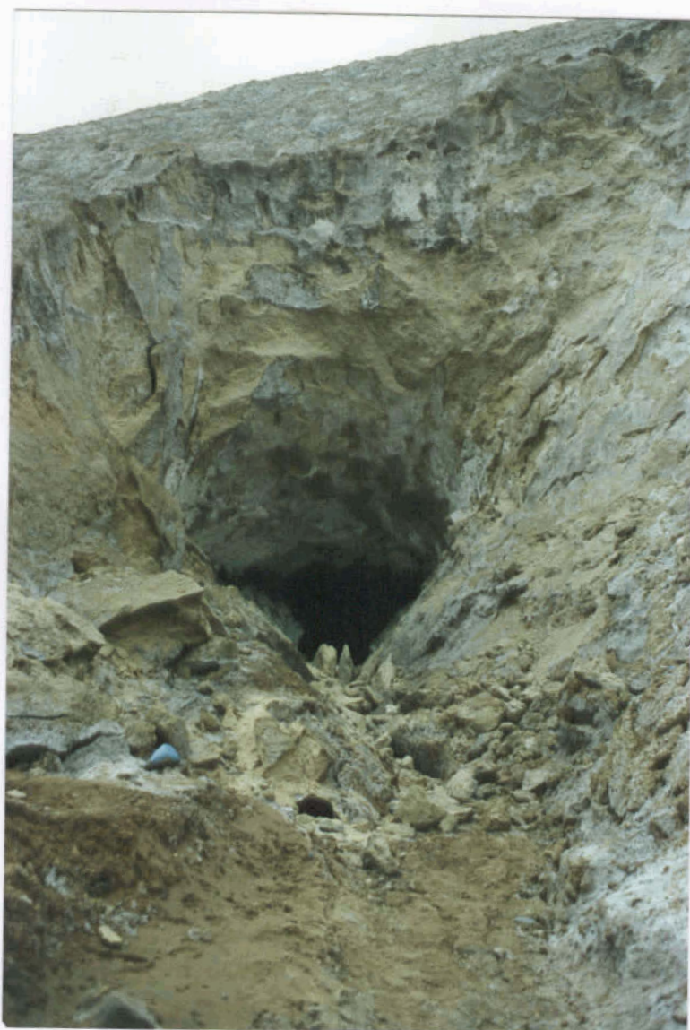
Foto núm. 14. Detalle de un hueco de disolución en la estructura 35-13-7-1, en Cardona.
