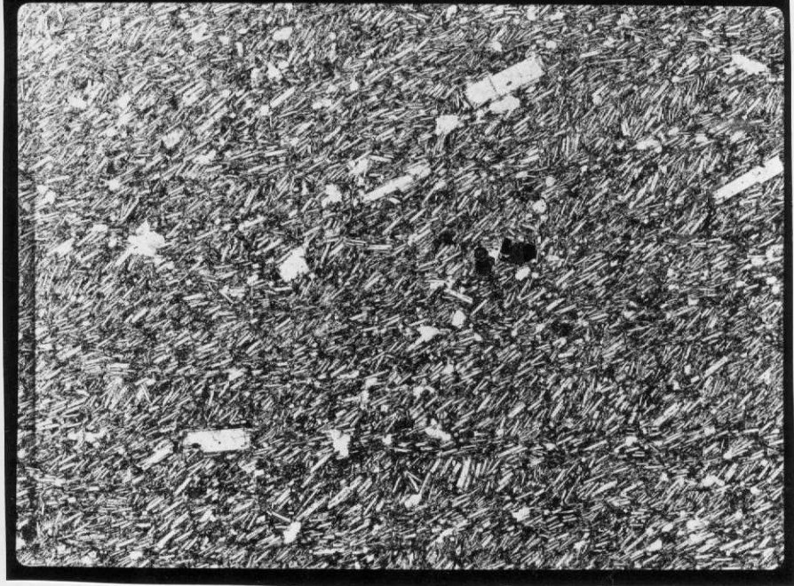
39-39-AD-VA-1641.- LN x 9. Fotomicrografía. Textura traquítica con orientación fluidal.
