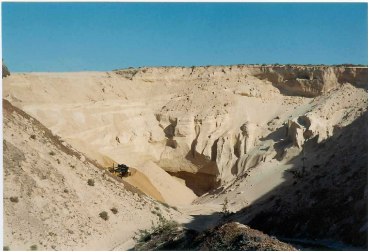
Fot. 17.- Potentes depósitos de arenas eólicas organógenas, que están siendo objeto de explotación industrial, en una cantera situada al este del Mala.
