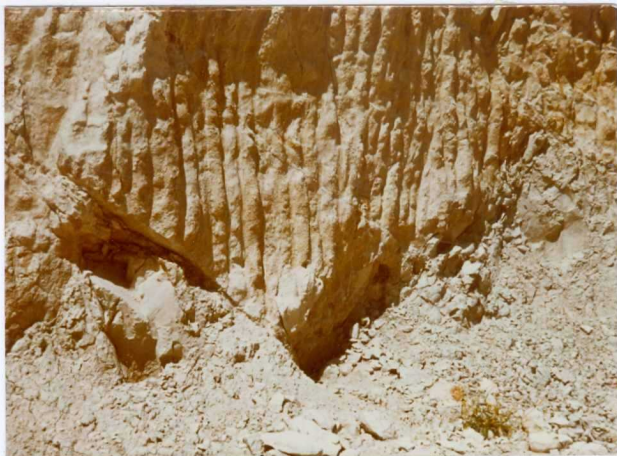
13-41-AD-LE-224. - Detalle de la misma cantera. Obsérvese las dos direcciones de fracturación y la diferencia de litología. En la parte inferior las margas y margocalizas de fractura foliar-concoide, en la superior las masivas de fractura foliar-hojosa.
