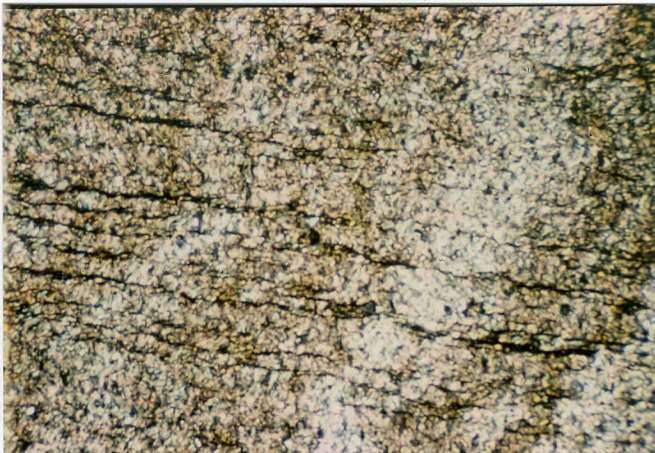
UNIDAD SIERRA DE LA LAPA. Formación Barrancos Ordovicio inferior Microfotografía nº 9 Típica pizarra de esta formación pre- sentando S_0 , S_1 y S_2 con sericita y cuarzo como com- ponentes principales. MUESTRA RG- 5116 Nicoles cruzados x 30 aumentos
