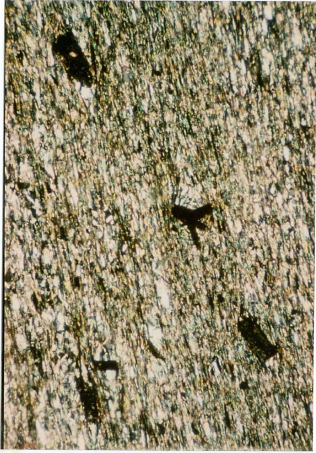
UNIDAD SIERRA DE LA LAPA. Formación Barrancos Ordoñez inferno Microfotografía nº 10 Porfiroblastos postectónicos de cloritoide en matriz pizarrosa de cuarzo y sericita. MUESTRA FL-54 Nicóles cruzados x 90 aumentos
