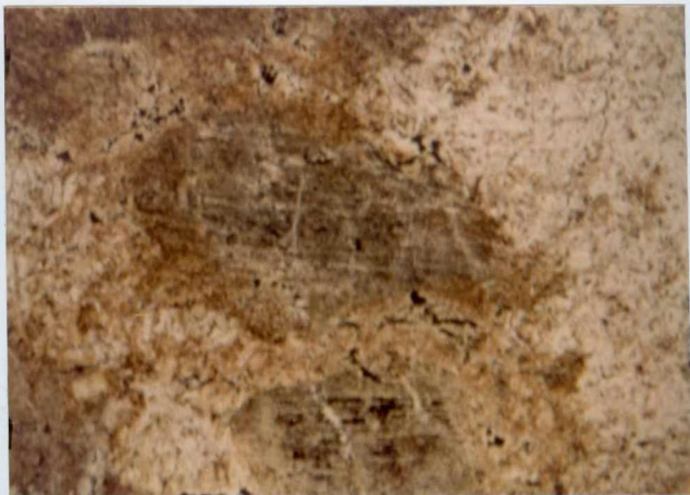
F-10.- Microfotografía de la lámina JF 112. Serpentinitas de la formación Malcocinado. Restos de piroxeno de finidos por orientación de opacos en planos 110, - en una masa totalmente transformada en antigorita (sin analizador x 27)
