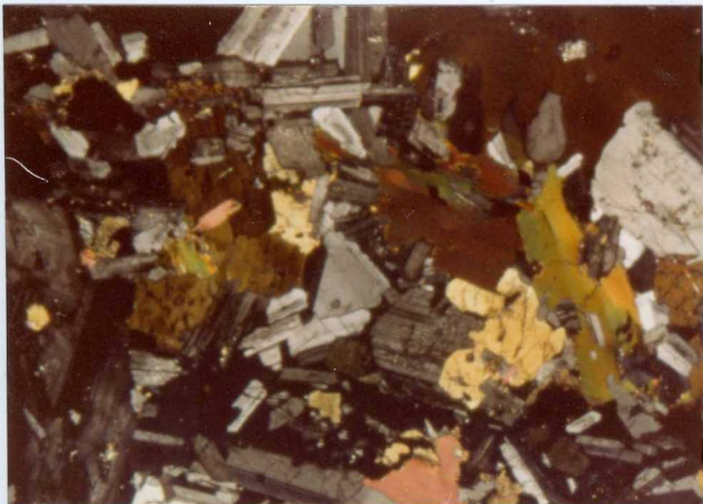
F-3.- Microfotografía de la lámina delgada JF 1. Diorita-monzodiorita. Mosaico heterogranular de plagioclasa (andesina-labrador), anfíbol tschermakítico (color amarillo dorado y marrón-verdoso en la foto) y biotita en placas (color rojo-verdoso) (con analizador x 27).
