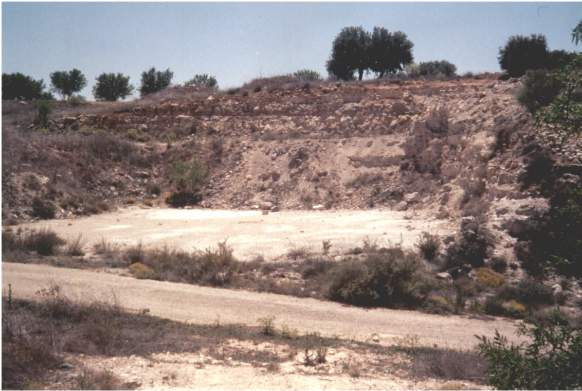
21-33-IN-FL-Fo13.- Pequeña cantera situada en el Km 21 de la carretera comarcal de Torrenueva a Torre de Juan Abad, en la que se han explotado las calizas de Gasterópodos del Mioceno Superior (30). En este sector los carbonatos ya tienen espesores decamétricos con intercapas o tramos margosos de color gris a beige.
