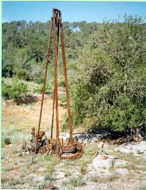
9512. Antigua maquina de sondeos hidrogeológicos abandonada en Tanques
