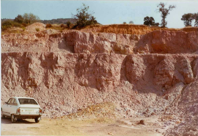
FOTO SV 9170.- Cantera explotada para extraer arcillas provenientes de la alteración de las pizarras de Calymene. Obsérvense los materiales cuaternarios que cubren las pizarras. Carretera Luciana a Puente Retama.
