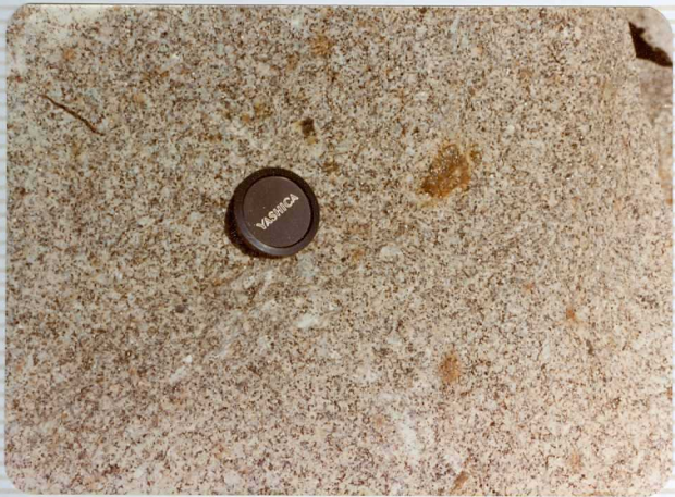
12/29 IB-GS-9317.- Cuarzodiorita típica con sus enclaves biotíticos muy corrientes.
