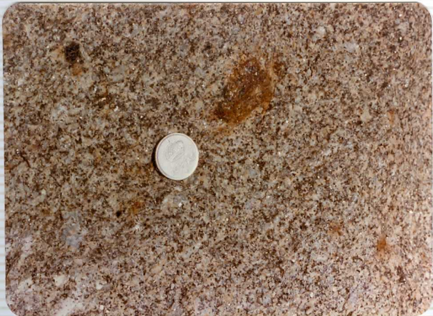
12/29 IB-GS-9316.- Cuarzodiorita típica con sus enclaves biotíticos muy corrientes.
