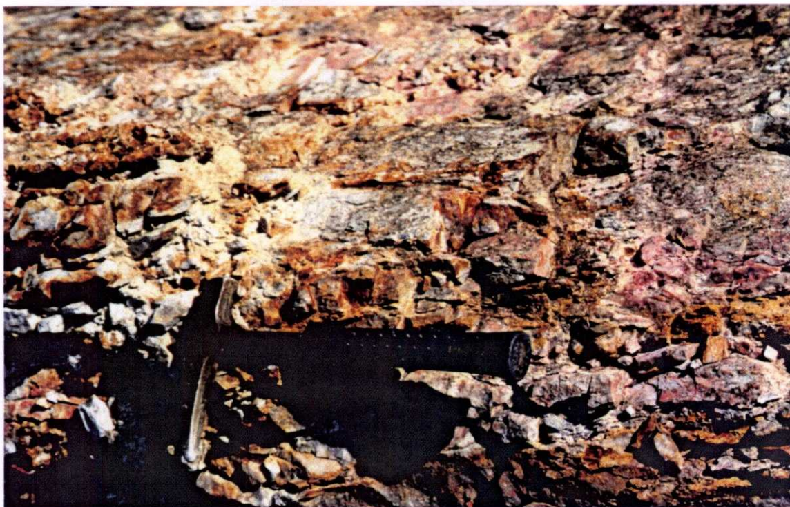
SC 9082.- Detalle de las cuarcitas de las fotos anteriores (15). Obsérvese el grado de fracturación y la abundancia de óxidos ferruginosos.
