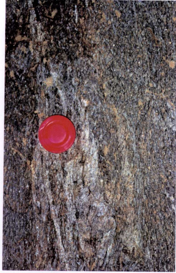
SC 9088.- Aspecto de los materiales pizarrosos (CEG) afectados por metamorfismo de contacto (14). Obsérvese el grado de recrystalización y la esquistosidad residual que da lugar a una corneana bandeada.
