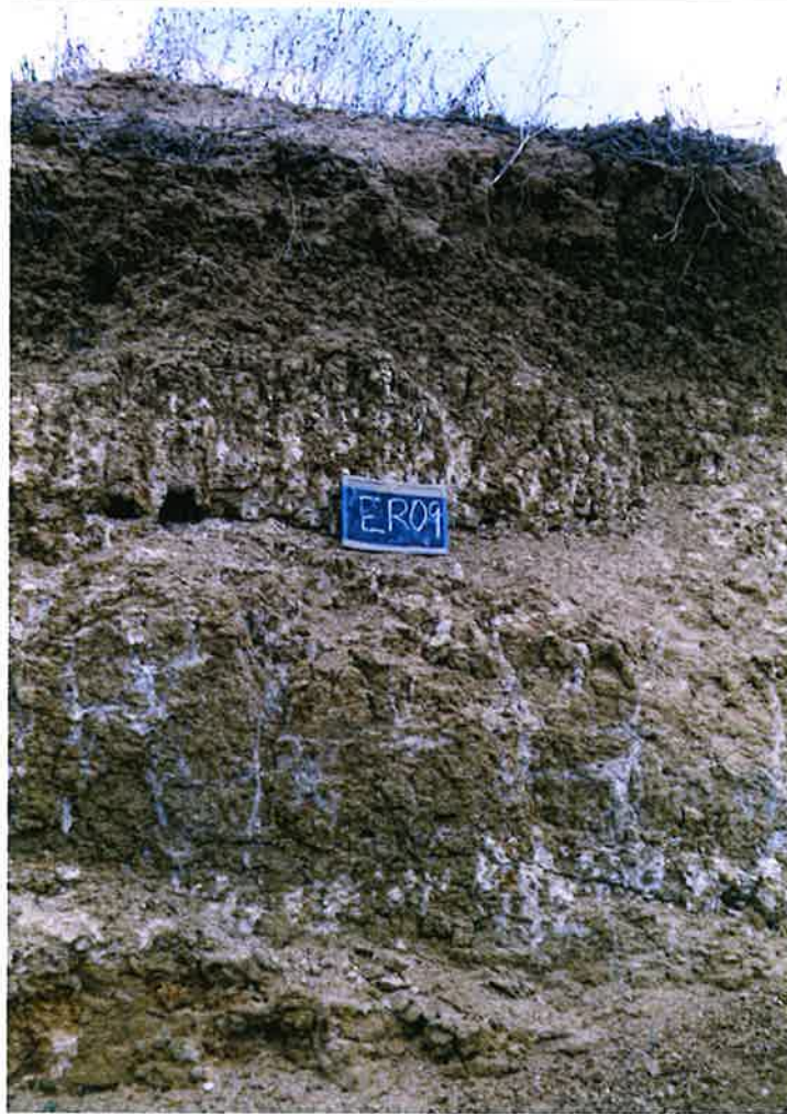
Foto 7. Perfil 19ER09. Horizonte argílico bien desarrollado, descalcificado en los primeros 30 cm. Obsérvese la calcificación preferente a favor de las caras de la estructura prismática bien desarrollada. (Arenero de Pantoja de la Sagra). Secuencia Ap-Bt-Btk-2C
