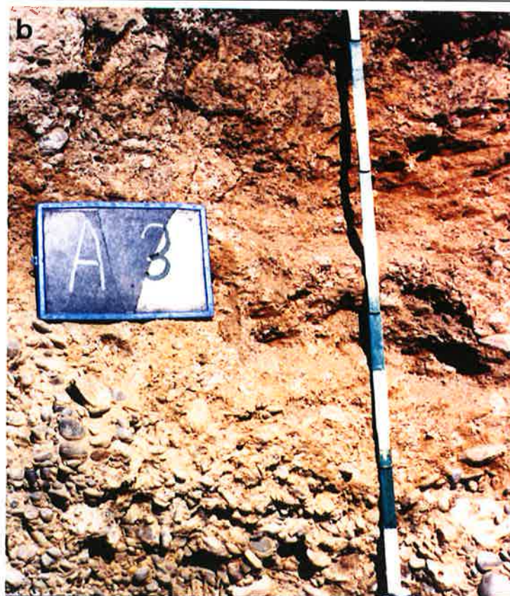
Foto 14. Perfil 1924ER11. Detalle del contacto de las facies de inundación con las facies de canal y barras de gravas.
