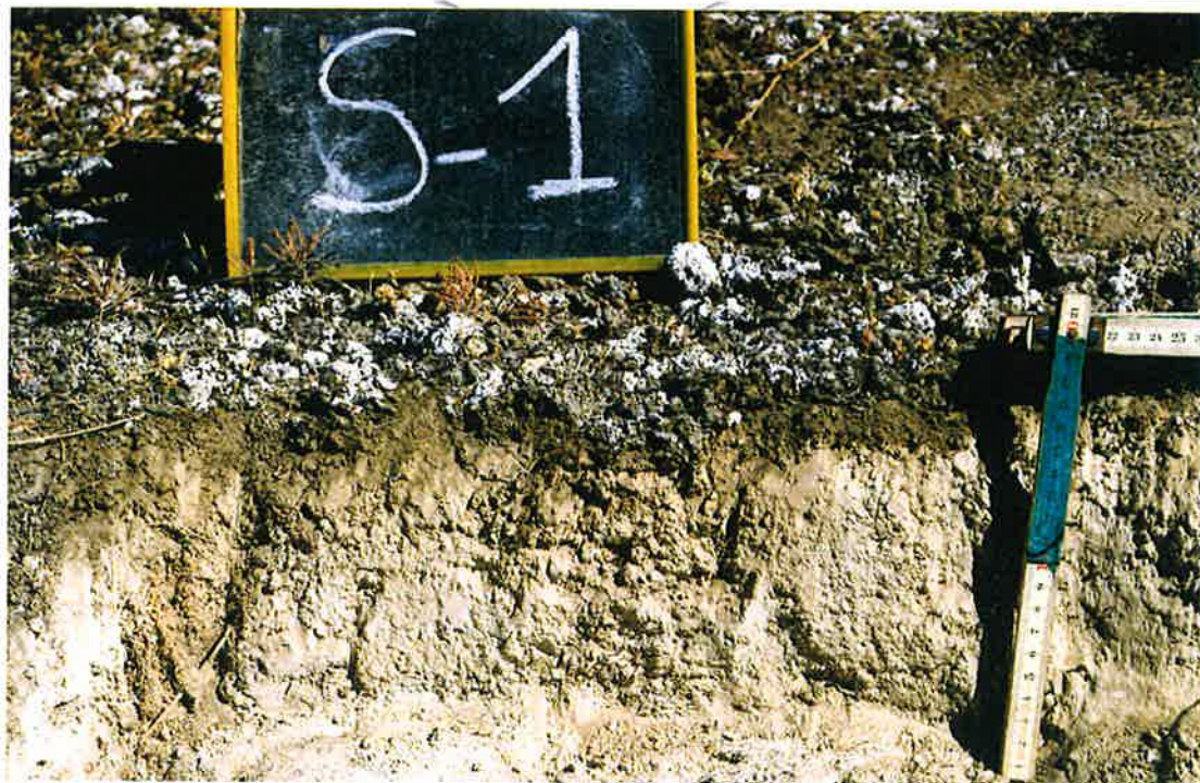
Foto 19. Perfil 1924ER14. Perfil del suelo en ladera de solana. Secuencia A-C. Obsérvese vegetación natural formada por líquenes.
