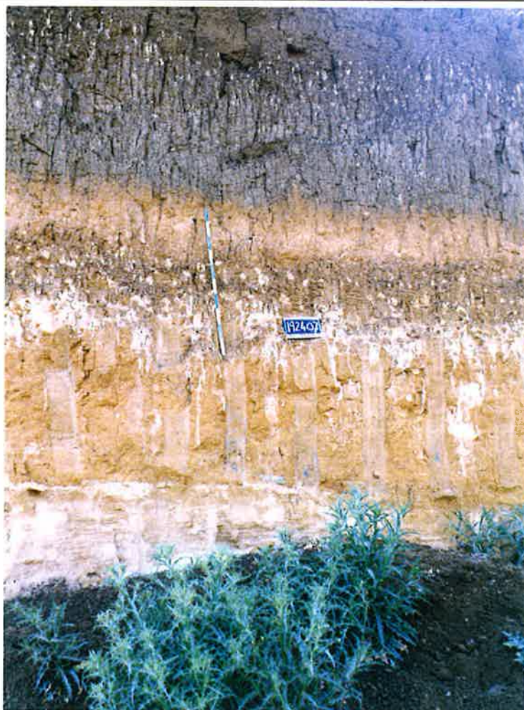
Foto 9. Perfil 1924ER07. Vista general del perfil en Cantera Hontalva (próximo a Pantoja de la Sagra). Perfil policíclico. Desarrollo fuerte de una estructura prismática en el horizonte argílico del ciclo superficial. Secuencia Ap-Bk-2Bt-3Bv-4C.
