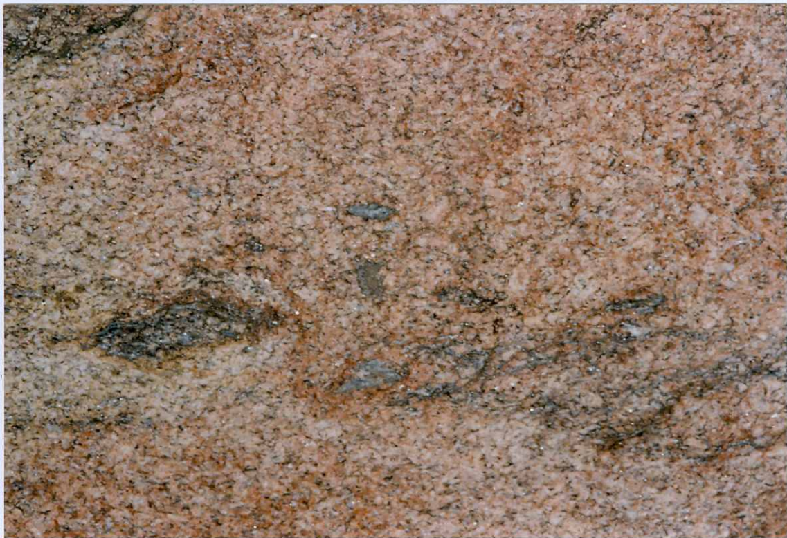
Variedad sin apenas megacristales con agregados restíticos (tipo "schlieren") biotíticos con sillimanita, marcando una fábrica N 110°E/70°N
