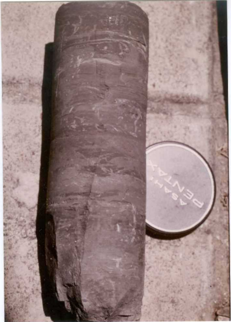
F.25.- Arcillas verdes bioturbadas, con deformaciones hidroplásticas. Unidad 6 del Mioceno. Sondeo del Polideportivo de San Blas (S.G.O.P.-2). Profundidad, 75 m.
