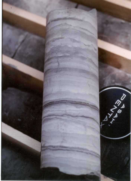
F.16.- Lutitas grises laminadas alternando con niveles finos de carbonatos (dolomita-magnesita). Unidad 3 del Mioceno. Sondeo S.G.O.P.-1, Avda de Portugal. Profundidad, 220 m.
