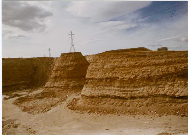
F.34.- Cantera de sepiolita junto al Caserío de Ambroz. Niveles de sepiolita en paso vertical a arcosas (unidad 9 del Mioceno).
