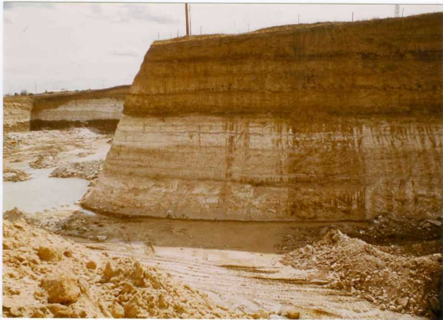
F.33.- Cantera de sepiolita junto a la Estación Clasificadora de Vicálvaro. Niveles de sepiolita con arcosas a techo recubiertas por arenas arcósicas cuaternarias.
