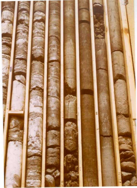
F.15.- Sondeo del Polideportivo de San Blas (S.G.O.P.-2) Contacto entre la unidad 6 de Arcillas verdes y arenas biotíticas y la unidad 2 de Yesos tableados con arcillas. Profundidad, 96 m.
