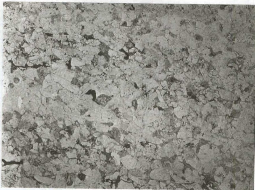
FOTO 3 (23-19-FM-4006) x 12 Arenisca (subarcosa) con cemento ferruginoso y ma- triz serícitica. Depósito terrígeno. BUNTSANDSTEIN
