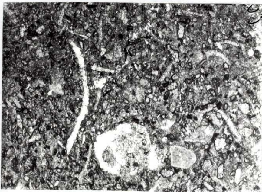
FOTO 10 (24-20-AG-2026) x 11 Un aspecto de dolomía de grano fino-medio, con som -- bras de intraclastos y fósiles (Lamelibranchios, Gaste rópodos, Aulotortus sp. Frondicularia af. woodwardi, Hemigordius sp., Algas y Equinodermos). Depósito costero. MUSCHELKALK MEDIO
