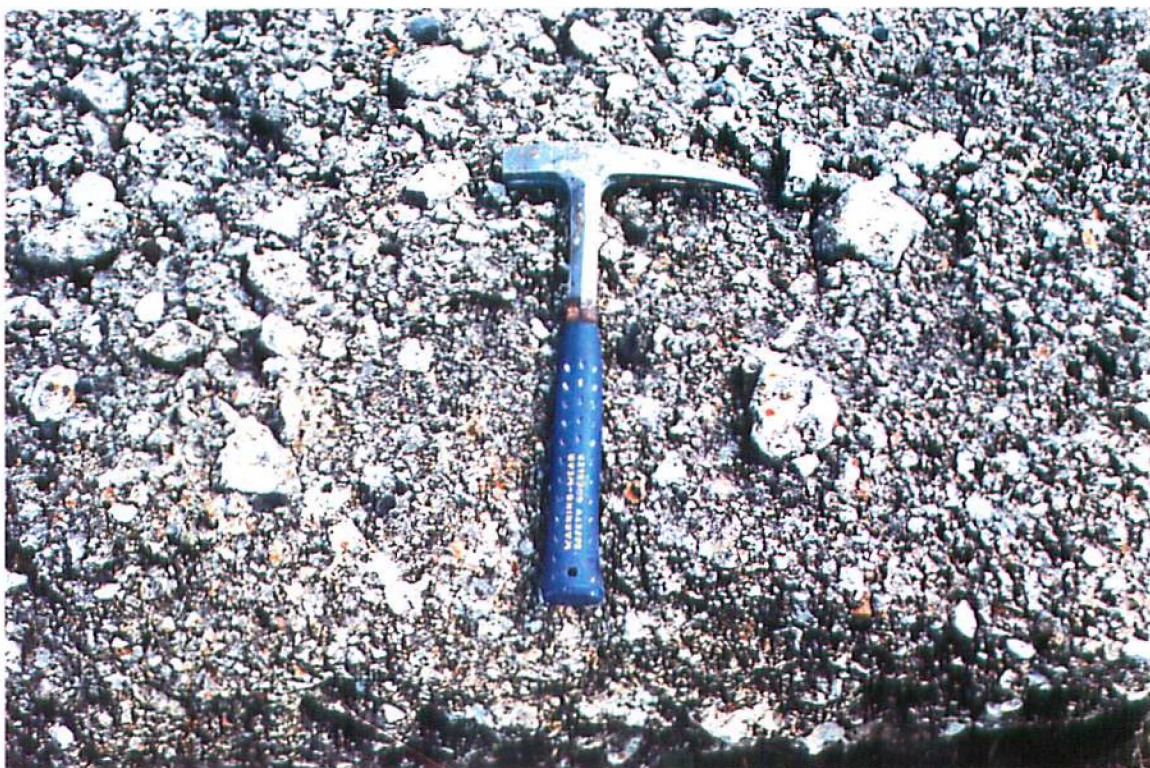
17-14/EP EN/9423 Terraza baja encostrada, en la que se aprecian cantos blancos de caliza blanca y alguna grava de cuarzo/cuarcita. km 8 de la carretera de Tudela de Duero a Castrillo de Tejeriego
