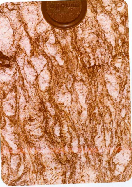
Textura gnéisica con grandes glándulas de feldespato y bandeado micáceo. Gneis glandular ( N_1 \xi^2 ) al E de Redondela. (Estación RN-370).
