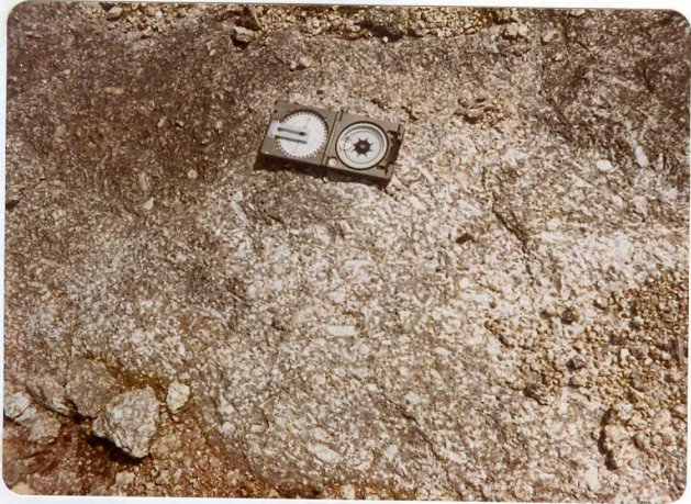
Aspecto de una foliación de granodiorita precoz en el borde SW de la Hoja. Se acusa la foliación cataclástica de la roca. (Estación RN-372).
