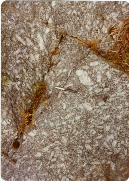
Detalle del tamaño de los megacristales y de la textura de las granodioritas precoces ( \gamma\eta^2 ) en el extremo W de la Hoja (Península de Morrazo). (Estación RN-78).
