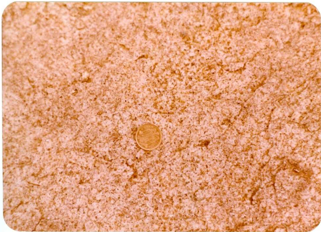
Detalle del granito de dos micas de grano medio (facies común). (A G - 432)
