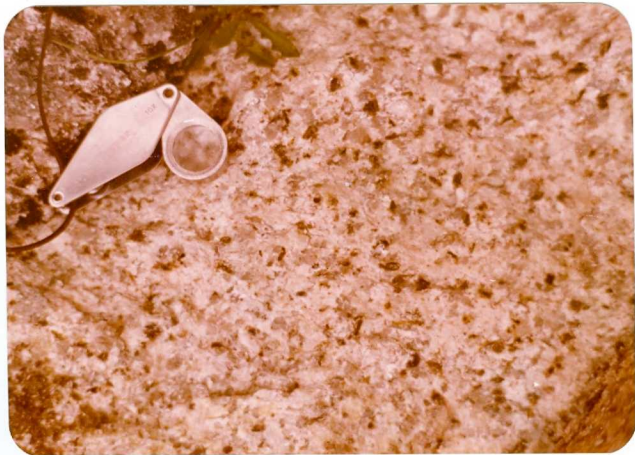
Detalle del granito de feldespato alcalino “de ala de mosca”, donde se observa su textura de grandes biotitas. (A 6 - 429)
