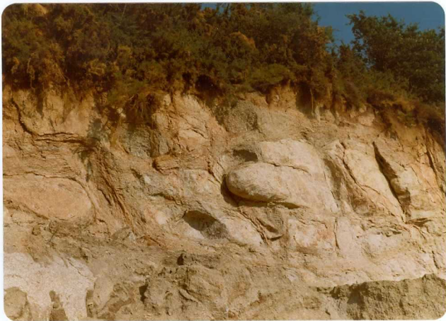
Cantera en la granodiorita de Caldas donde aprovecha los gruesos bolos para la obtención de piedras de construcción y la roca alterada y degradada como material granular (arena silíceas). (Estación AH-96b)
