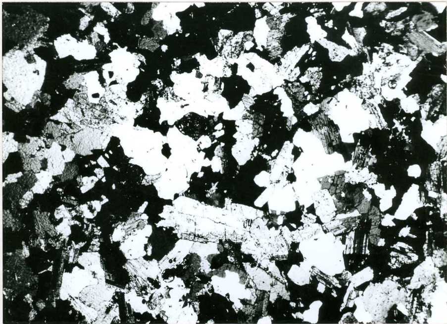
10-09-AD-GU-74 . - Leucogranito moscovítico granatífero. NX. ( \gamma^3 )
