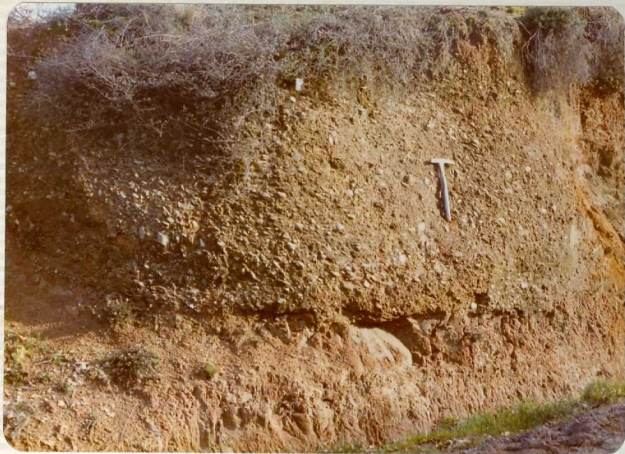
720.- Lentejón de gravas de cuarci ta y pizarra con una cierta orientación intercalado en las arcillas del miembro Fuenteabuín (Ta).
