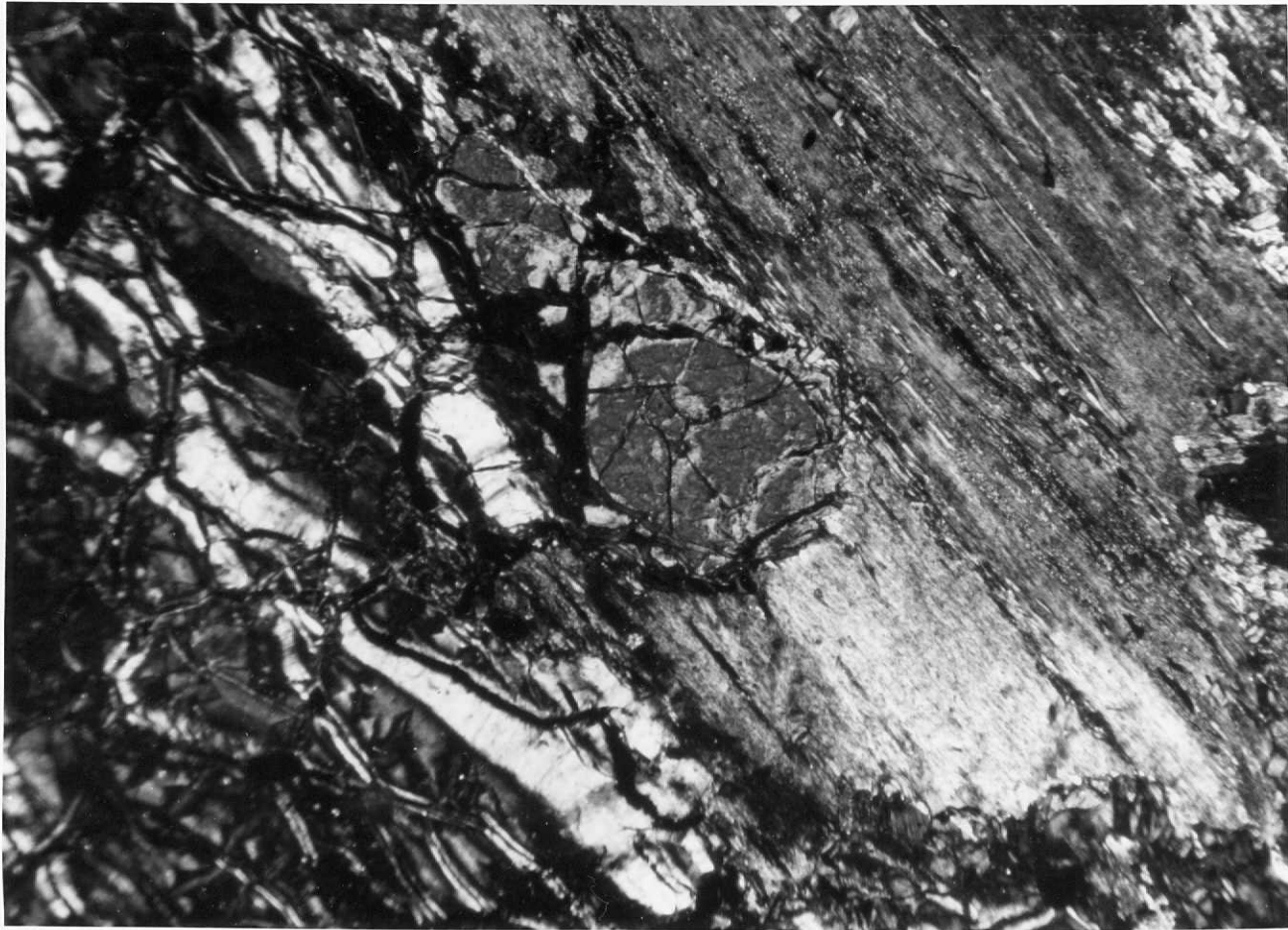
DR. 0124.- Metaperidotita. Cristal de Antofilita (?) incluyendo olivino en matriz serpentizada. N.X. x 40.
