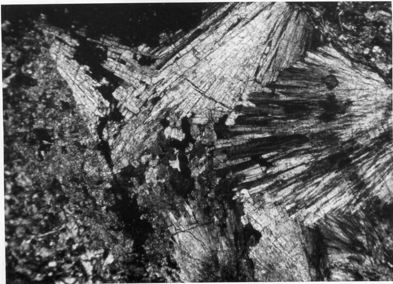
DR. 0307.- Metavulcanita Básica, metaespilita (Periférico Ordenes). Vacuolas rellenas de crecimientos radiales de Epidota. N.X. x 40.
