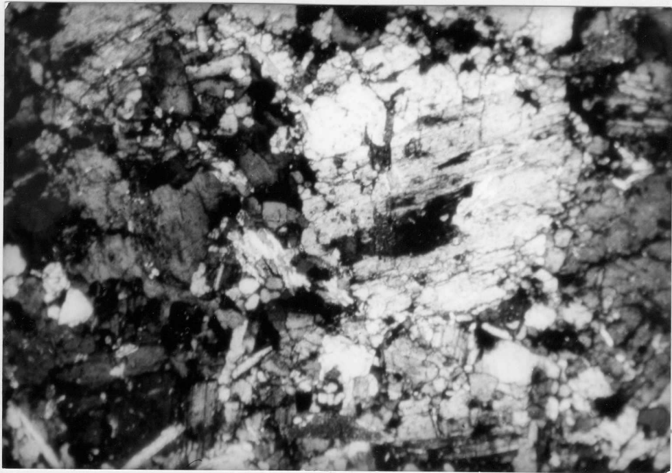
Foto 03-08-TC-DR-0017.- Granito anatexítico tipo Muros (L.P. x10).
