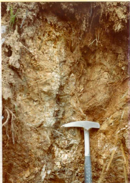
MC-1149.) Contacto de los esquistos de Ordenes (PC-CA) con el Ortoneis ( N\gamma n^1 ).
