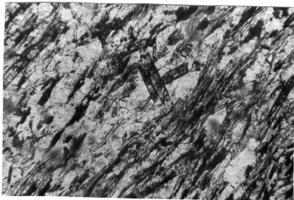
Foto 7.— (TD—249).— Esquisto de moscovita, cuarzo y clositoide. Este último es posterior a la deformación que origina la esquistosidad principal apreciable en la fotografía. Nícoles paralelos 50 aumentos. (AH1—36)
