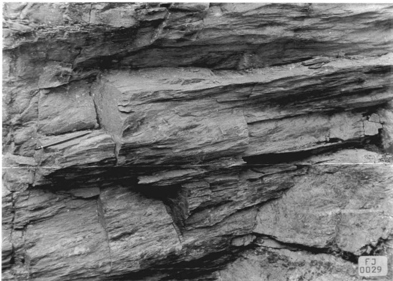
FJ-0029. - Aspecto que presenta en el campo un tramo pizarroso de la Serie de los Cabos. Obsérvese la existencia y frecuencia de diaclasas transversales (CA 2 -O 1p )
