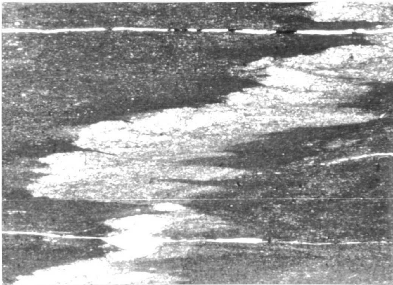
4001.- Esquistosidad de flujo intersectando oblicuamente a la estratificación originando micropliegues con fenómenos de disolución por presión. 270X
