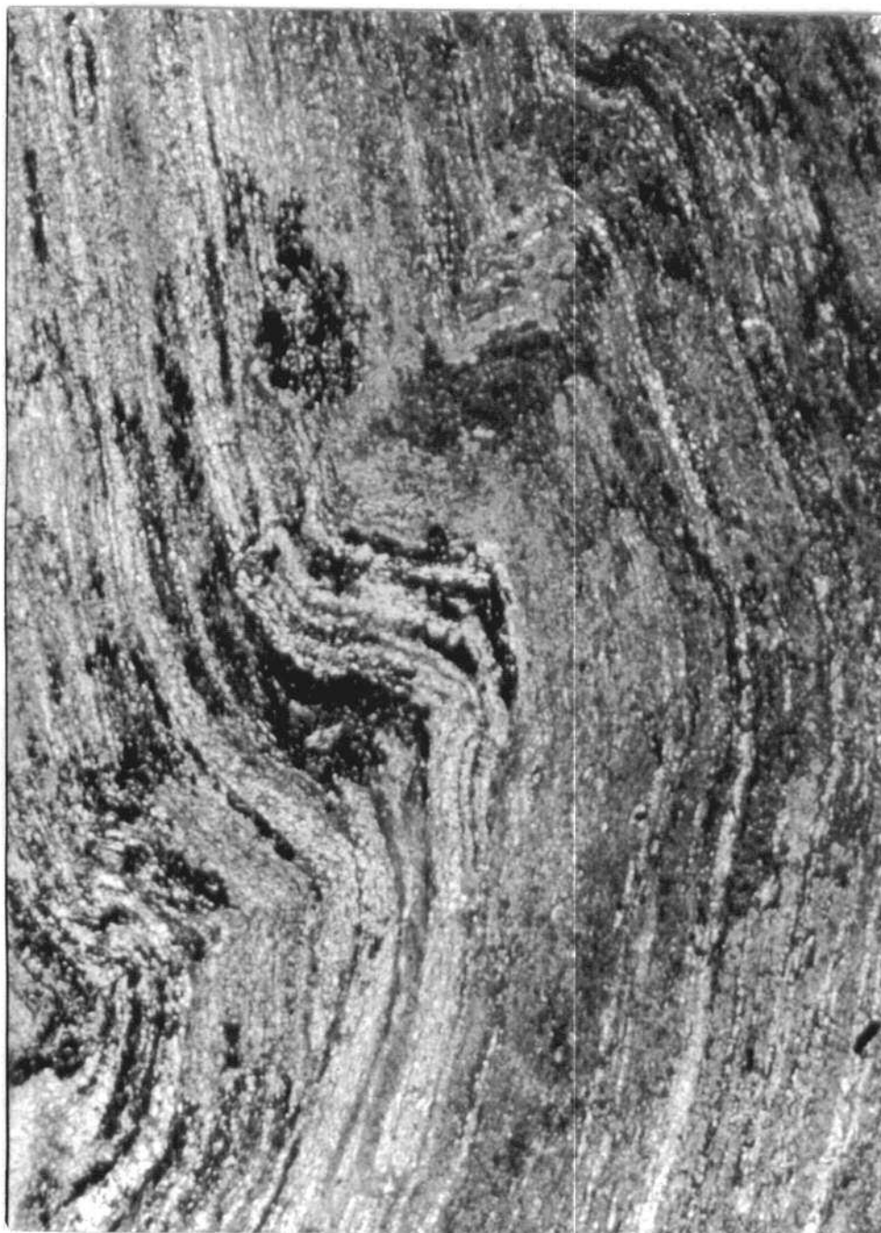
4047.- Micropliegue de tipo Kink-band inverso en el que la compresión principal es lateral según se observa la fotografía. 300X
