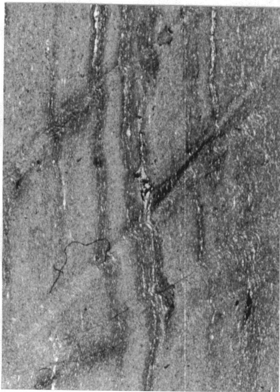
4025.- Esquistosidad de flujo paralela a la estratificación con crenulación poco penetrativa. 330X
