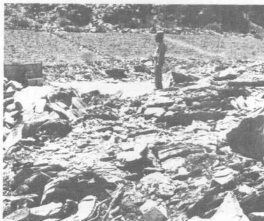
Foto 6.— Canteras de fonolita en el Cañón del Aguila (Serie Fonolítica). Se emplean, como piedras de construcción, para enlosados y revestimiento de zócalos. (B17H-32,33).
