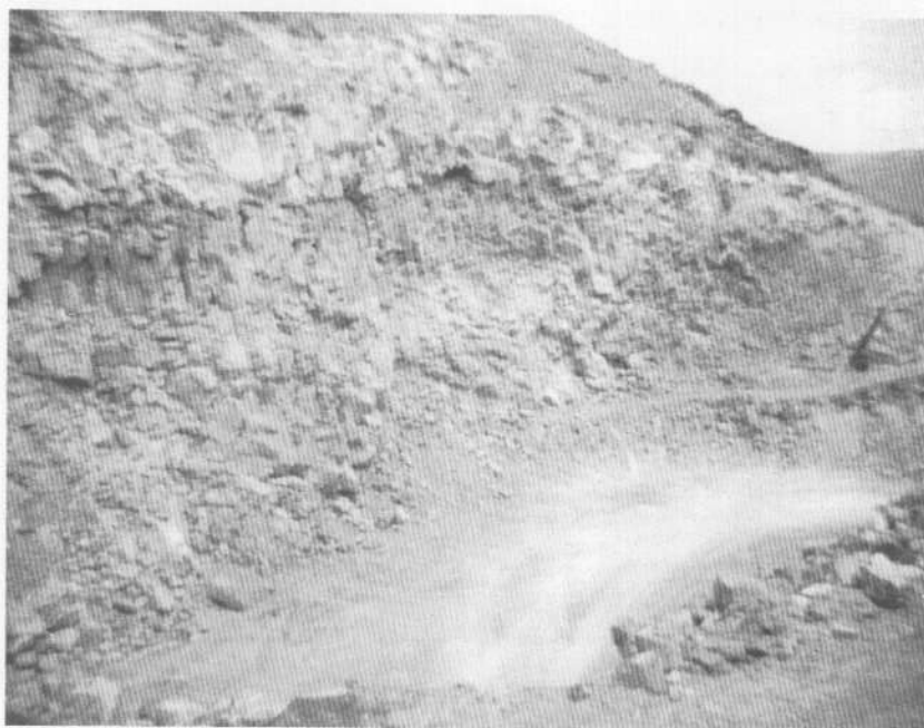
Foto 1.— Explotación de basaltos de la Serie I para áridos de trituración en Ampuyenta en Fuerteventura.
