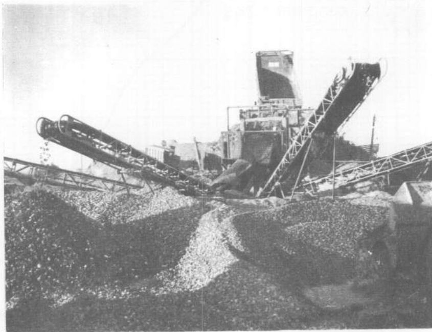
Foto 5.— Detalle de una planta de clasificación de gravas. En primer plano, cintas de distribución por tamaños.
