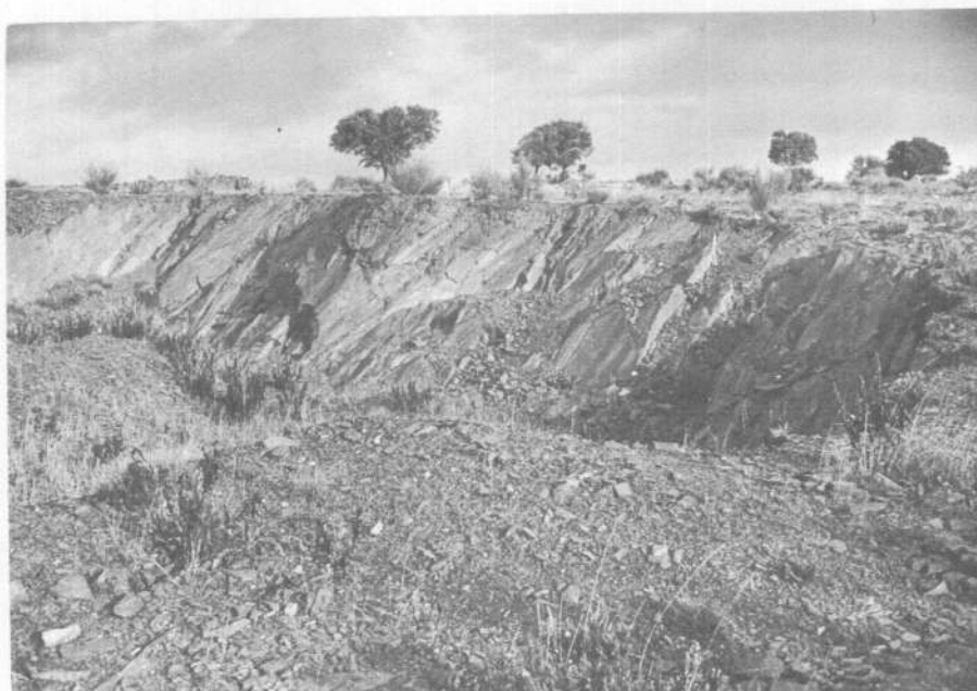
Foto 8.— Cantera de pizarras cámbricas, para construcción de viviendas, en Serradillas (E-71)
