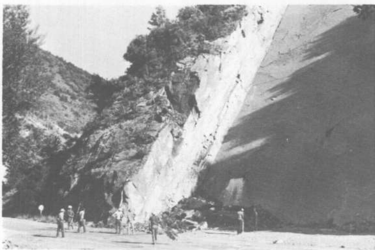
Foto 5.— Explotación de calizas arenosas en el Puente de Torrijos (Jaca), aprovechando el fuerte buzamiento de las capas.
