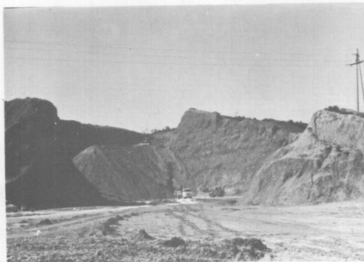
Foto 8.— Explotación de arcillas miocenas en Olite. Se aprecia la intercalación de capas areniscas duras en la formación.
