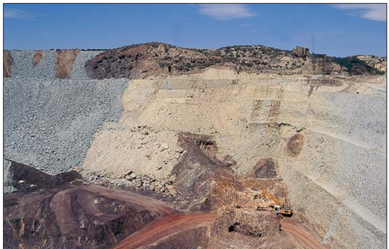
Foto 16.3. Mina de las Herrerías (baritina). Cantera de Minersa. Detalle de la anterior, donde se ve cómo avanza el relleno a medida que progresa la explotación; por encima de la excavadora, "canto" de mineralización alojado en las margas de techo.
