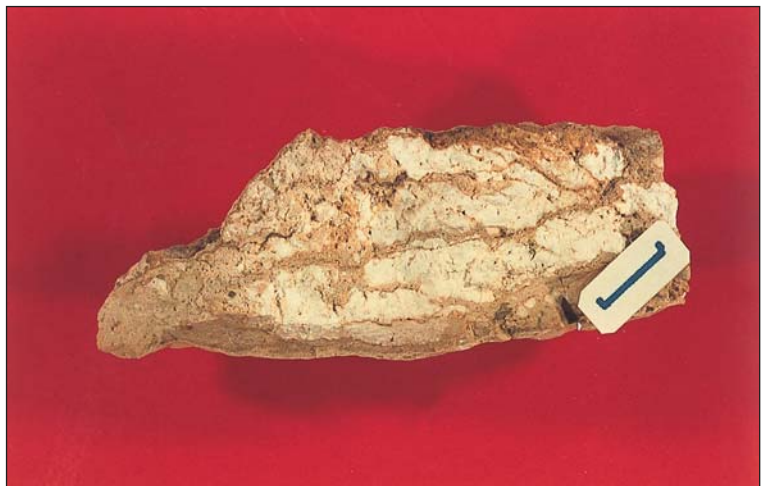
Foto 18.3. Magnesitas de Sierra de Gádor. Nódulos de magnesita en un fragmento de costra.
