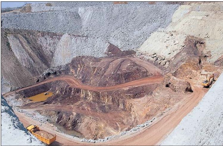
Foto 16.2. Mina de las Herrerías (baritina). Cantera de Minersa. En la derecha, la excavadora trabaja sobre la "capa" de baritina-jaspes; inmediatamente a la izquierda, zona de la plata; el resto son las calcarenitas mineralizadas en hierro con filones de baritina.
