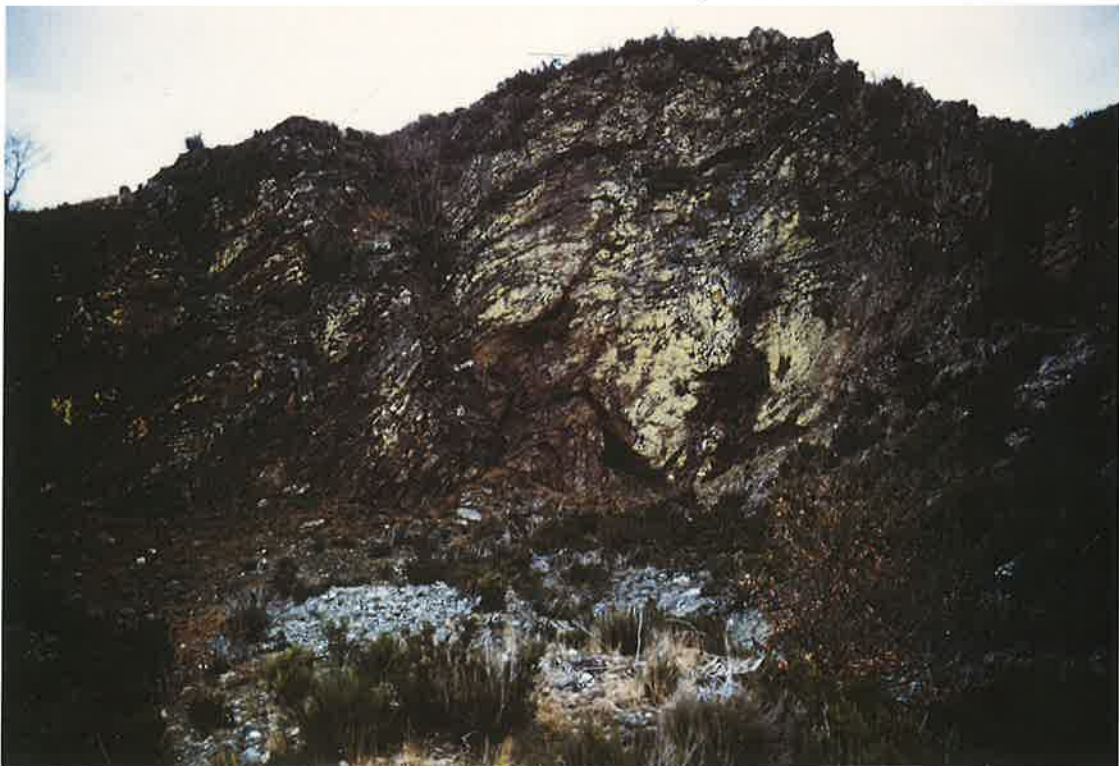
Foto 2: Frente de explotación de la mina de la Toca. La mineralización se encuentra como rellenos filonianos en fracturas en los flancos inversos de los pliegues o reemplazando a las areniscas de la Serie de Cándana.
