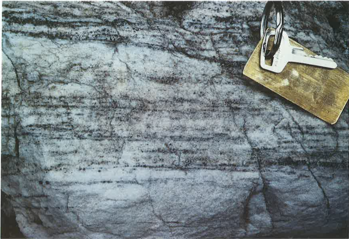
Foto 9: Mineralización estratiforme de esfarelita, galena y pirita en calizas del muro de la Caliza de Vegadeo. Minas de Visuña (num. 14)
