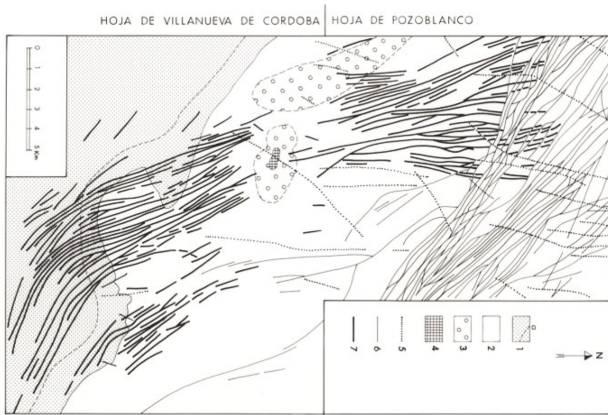
Fig. 6.- Geometría del haz granodiorítico. 1) Metasedimentos. 2) Granodiorita (facies común). 3) Zona de mezcla. 4) Leucogranitos. 5) Filones de cuarzo. 6) Diques de pórfidos riolíticos. 7) Diques de pórfidos granodioríticos
