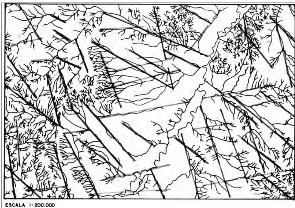
Figura 3.11. Esquema de la red de drenaje con las principales direcciones de circulación del agua.
