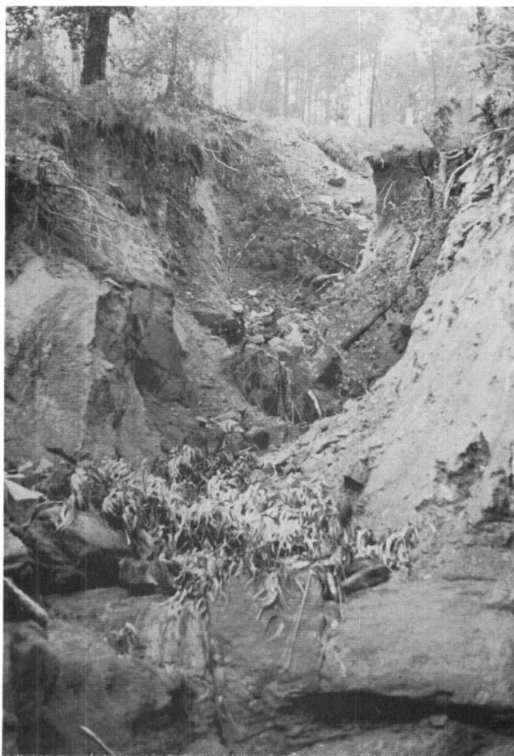
Foto 11.- Escarpe de flanco derecho en el deslizamiento de Casal do Monte
