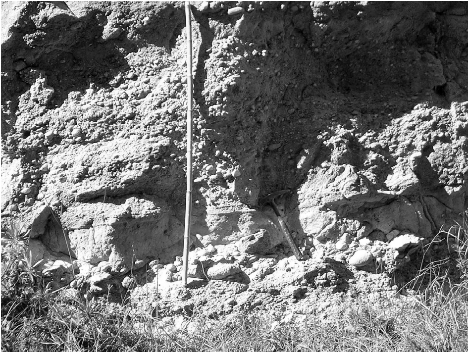
Figura 2.15. (Foto 63). Conglomerados polimicticos, heterométricos, granosoportados y bien redondeados (18). Puerto del Garruchal. Carretera de Los Garres a Las Casas del Cura.
