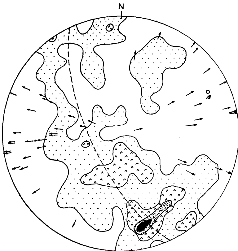
DIAGRAMA 1.- 84 polos de S_0 (contornos 1,3,5,7%) y 45 L_1 en el SINCLINAL CARBONIFERO CENTRAL N65E → 20E
