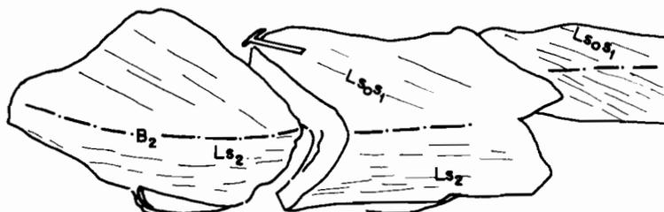
Fig. 4.— (IB—JL—1266). Pliegues de Fase II con eje curvo en Molinos de Celán.  $B_2$  es el eje del pliegue.  $LS_2$  lineación correspondiente a los ejes de micropliegues.  $LS_0S_1$  es la lineación de intersección de la estratificación y la esquistosidad primaria. La lineación  $LS_0S_1$  intersecciona a  $B_2$  con distintos ángulos sin que existan deformación del plano axial o de la lineación  $LS_0S_1$ .
