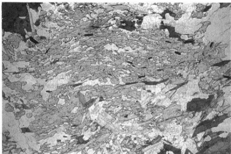
Fig. 35.- Fotomicrografía de un poiquiloblasto de andalucita posterior a la esquistosidad principal a la que incluye. Area situada al O. del domo migmatítico de Celanova-Bande. Muestra MAGNA (Luz paralela, 40 X).
