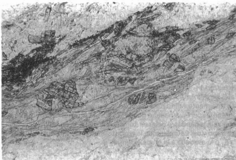
Fig. 37. Fotomicrografía de blastos de distena en un micronivel pelítico en cuarcitas. Dominio del Caurel. Muestra MAGNA (Luz paralela, 100 X).
