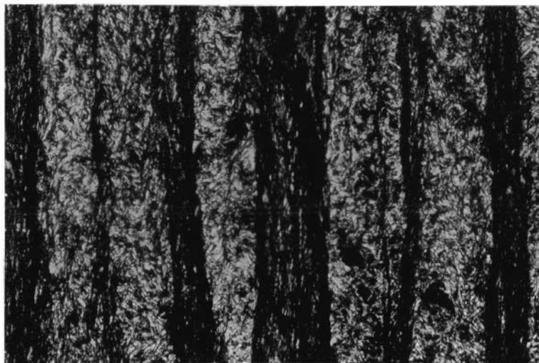
Fig. 13.- Fotomicrografía. Bandeado tectónico de Fase 2. Esquistos del Grupo de Paraño (125 X, Nícoles cruzados).
