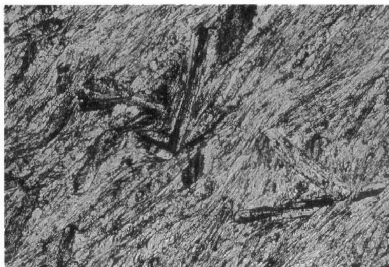
Fig. 26.- Fotomicrografía de cristales de cloritoide. Hoja de Monforte de Lemos (156). Muestra MAGNA. (Nícoles cruzados, 100 X).
