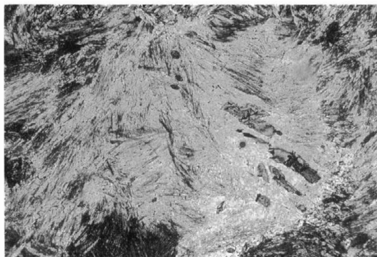
Fig. 28.- Fotomicrografía de un poiquiloblasto de moscovita englobando sillimanita prismática a la que reemplaza. Hoja de Lovios (301) Muestra MAGNA (Nicoles cruzados, 100 X).
