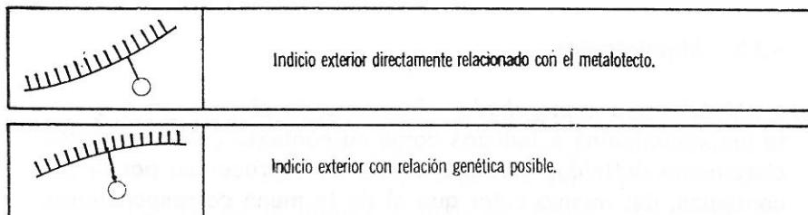
*Metalotecto y yacimiento distanciados.* Si el yacimiento no se encuentra incluido físicamente en el metalotecto, pero puede tener una relación con él (por ejemplo, filones de Sn en pizarras y existencia de un granito próximo), ésta se puede sugerir mediante una flecha de trazos uniendo el indicio con el metalotecto probable.
