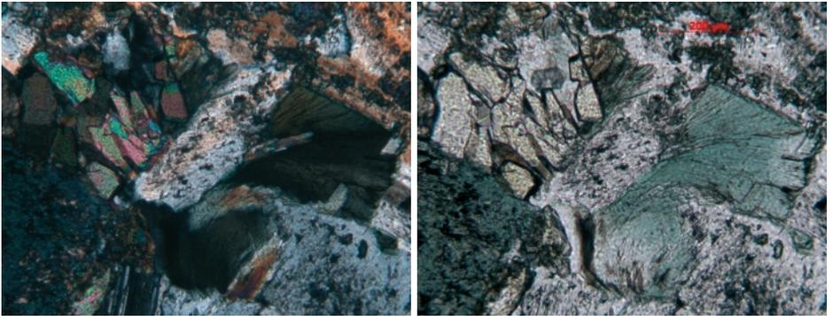
**Figura 59.** Asociación mineral de actinolita, clorita, plagioclasa, epidota e ilmenita que caracteriza a las metabasitas de la Unidad de Enmedio (10)
