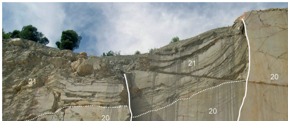
Figura 4. Contacto entre las calizas oolíticas de la unidad cartográfica (20) y las calizas nodulosas rojas de la unidad cartográfica (21)
