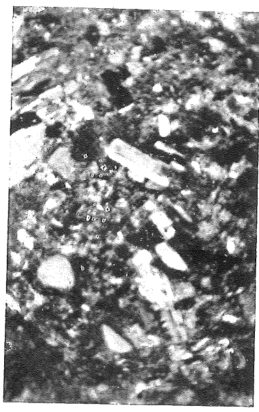
Pórfito diorítico de las canteras del Puig Mari, lado de Las Irlas. L. ord. y N. + 15 d. Fenocristales de plagioclasa, de biotita y de cuarzo corroído, sobre pasta microgranuda de los mismos componentes.
