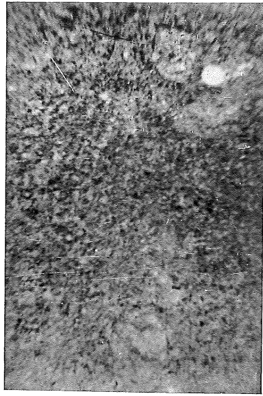
Porfírita andesítica muy alterada, Km. 18-19 de la carretera de Pradell a Dosaiguas. L. ord. y N. + 20 d. Fenocristales pequeños de plagioclasa y de biotita muy alterada, pasta microlítica, esencialmente plagioclasa, con algo de biotita y magnetita.
