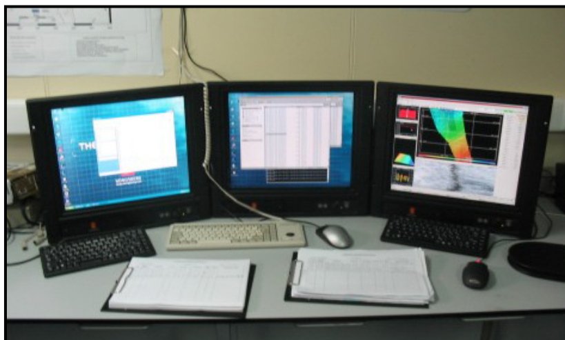
Figura 9. Unidad de adquisición y control en tiempo real de la ecosonda multihaz.
