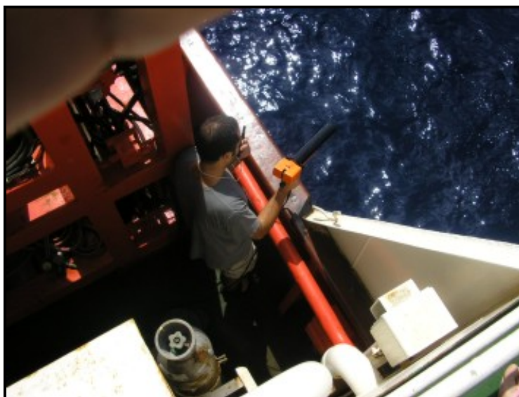
Figura 7. Lanzamiento de un batitermógrafo desechable o XBT.
